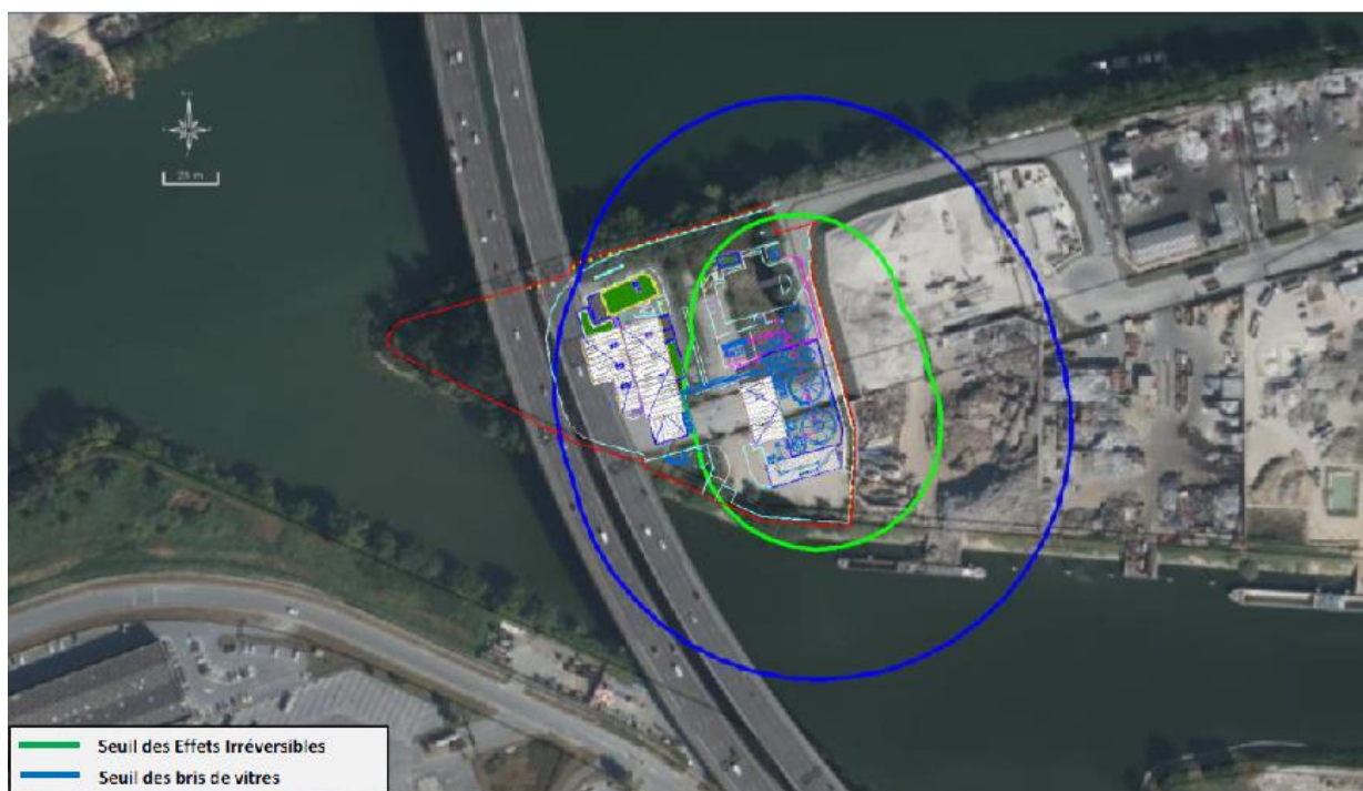
Figure 6 Cartographie des effets de surpression hors des limites du site tous phénomènes dangereux confondus à hauteur d'homme. (Figure 3 de la PJ49a Résumé de l'étude de dangers)
